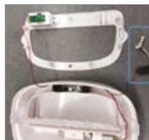
Generador de ozono integrado
