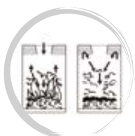
Principe d'auto-extinction Löschprinzip
